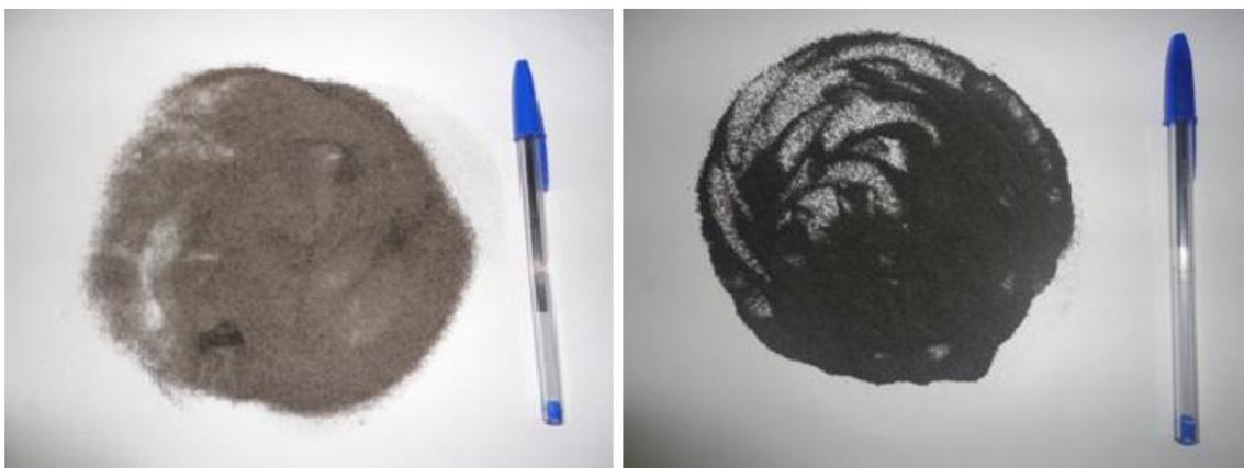
**Figura 1 – (a) Aspecto da cinza leve; (b) Aspecto da cinza pesada. Fonte: Elaborado pelos autores.**
