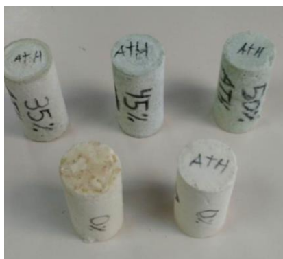
Figura 3: Corpos de prova de PU, PU/ATH e PU/ATH/PET utilizados para os testes de isolamento térmico e de resistência mecânica. Fonte: Elaborado pelos autores.
