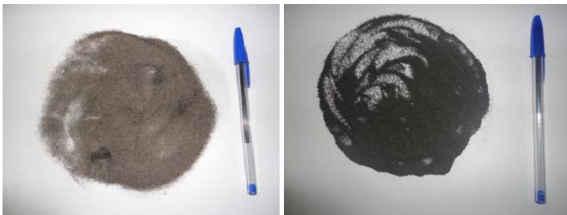
Figura 1 – (a) Aspecto da cinza leve; (b) Aspecto da cinza pesada. Fonte: Elaborado pelos autores.
