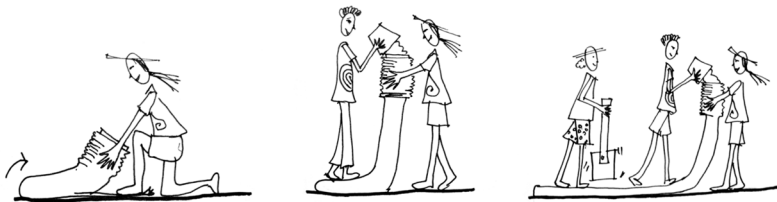
Figura 2: Passo a passo da taipa ensacada: os sacos são enchidos com a ajuda de funis e logo compactados. Adaptado de Prompt, 2008
