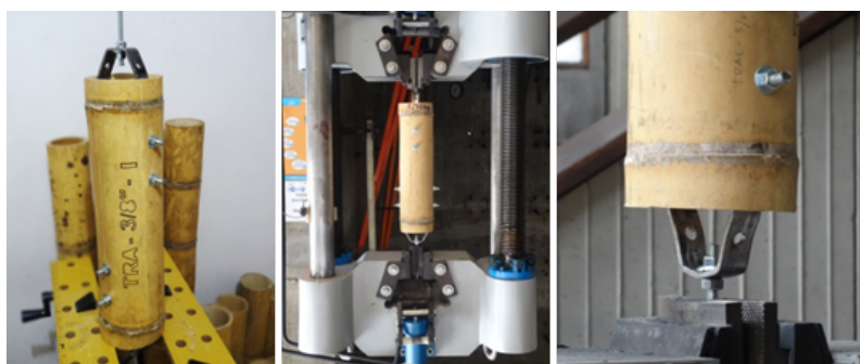
Figura 7. Procedimento do ensaio de tração no corpo de prova. Fonte: Elaborada pelos autores.
